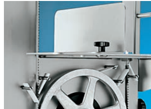
Raschiatori lama in materiale plastico alimentare ad innesto rapido. Flangia in materiale plastico alimentare nero a tenuta stagna per protezione motore Alimentary plastic blade scraper in quick to insert. Watertight black plastic flange to protect the motor
